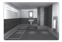
**6** Marquez le sol afin de délimiter les éléments fixes ne pouvant être chauffés.
