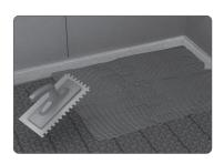
1 Recouvrez la membrane installée avec une colle à carreler flexible de type C2S-S1 en utilisant une spatule dentelée. Prenez soin de ne pas déloger le câble de la membrane. Si l'installation est faite avec des tuiles plus petites que 6" par 6", nous recommandons d'appliquer 1/2" d'autonivelant avant d'appliquer la colle à carreler.
