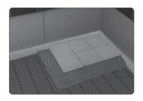
2 Installez les carreaux et assurez-vous de créer un bon contact entre la colle et la membrane. Si nécessaire, faire une pose en double-encollage. Lors de la pose de la céramique, il faut s'assurer que les joints de la céramique n'arrivent pas vis-à-vis un des joints de la membrane. Il est important de toujours croiser les deux joints.
