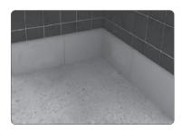
2 Assurez-vous que le plancher support soit lisse, sec, propre et sans aucune poussière. Il est recommandé d'utiliser un apprêt de type SBR standard après avoir nettoyé et séché le sous-plancher.
